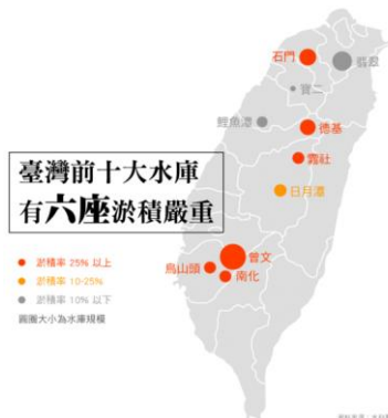
圖一：台灣當前水庫淤積情形
